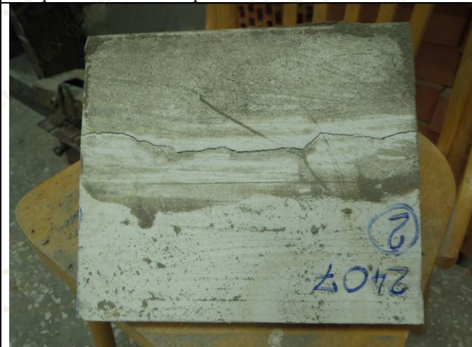
Фото 15. Осмотр дефектов после разрушения образца. Видна горизонтальная трещина шириной 2-2,5 мм на всю длину образца.
