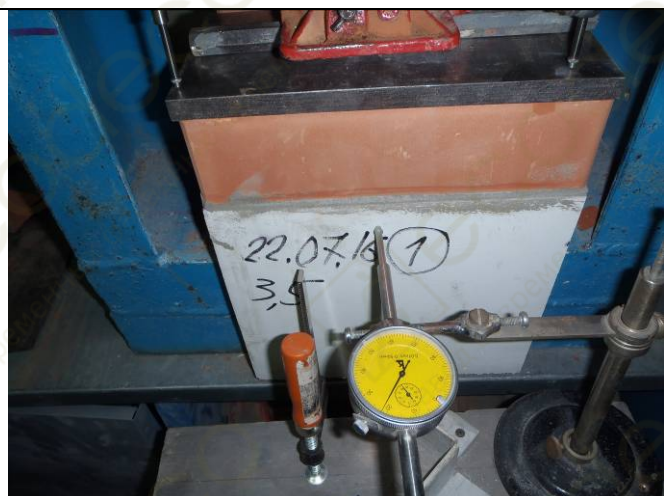
Фото 36. В ходе опыта определяем величину разрушающей нагрузки и величину перемещений (по установленным индикаторам) при заданной величине консольного свеса образца – 3,5см.
