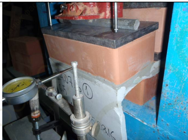
Фото 9. В ходе опыта определяем величину разрушающей нагрузки и величину перемещений (по установленным индикаторам) при заданной величине консольного свеса образца – 6,5 см.
