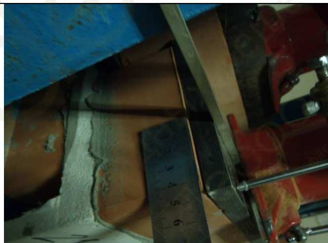
Фото 34. Осмотр дефектов после разрушения образца.
