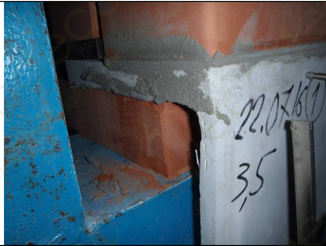
Фото 37. Образец уголка декоративных накладок из стеклофибробетона УГ 3-1 после испытания.
