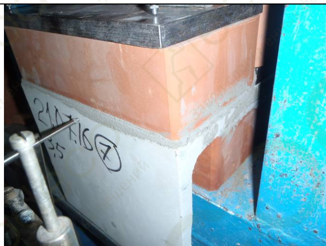
Фото 39. Осмотр дефектов после разрушения образца.
