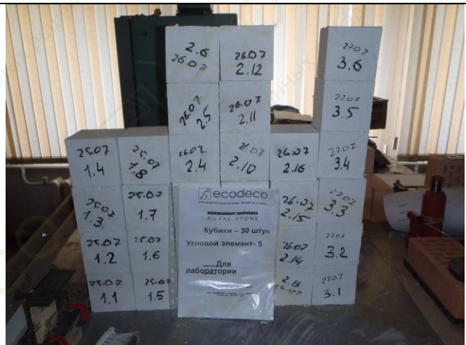
Фото 2. Место проведения испытаний - строительная лаборатория. Выдержка образцов в нормальных условиях до проведения испытаний – 28 календарных дней.
