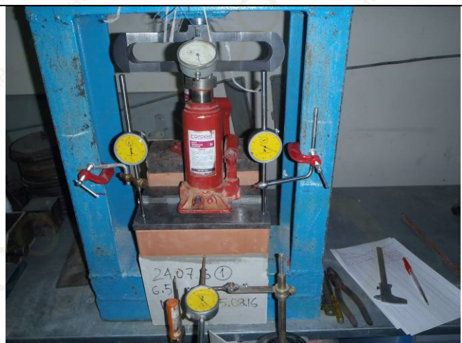
Фото 8. Общий вид испытательного стенда для определения максимального свеса полки уголка декоративных накладок-уголков из стеклофибробетона со свесом 6,5 см от опоры. Испытание образца УГ1-1 А.
