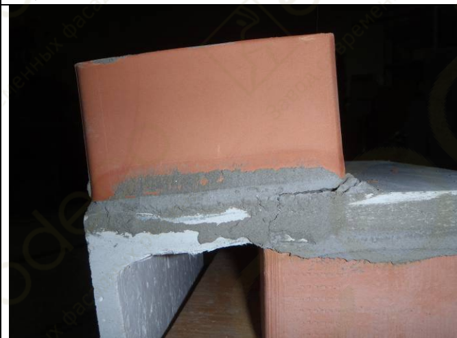
Фото 21. Осмотр дефектов после разрушения образца. Видна наклонная трещина шириной раскрытия 1,5-2 мм в полке образца.
