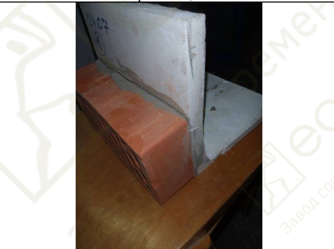
Фото 11. Осмотр дефектов после разрушения образца. Видна горизонтальная трещина шириной 1,5-2 мм на всю длину образца с наклоном в сторону опорной зоны.
