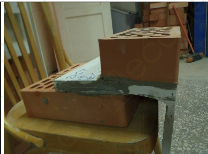
Фото 13. Разрушение образца под действием нагрузки. Для контроля перемещений при загрузке испытываемого образца по принятой схеме используем показания индикаторов: два вертикального и один горизонтального направления
