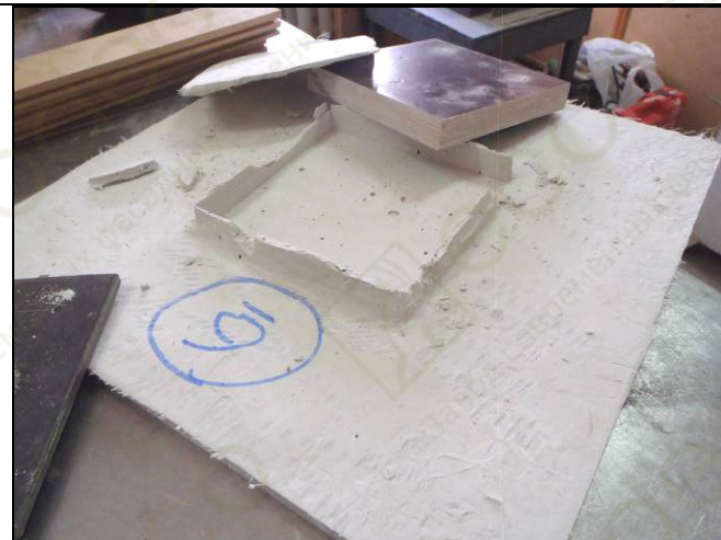
Фото 25. Испытание крепежного подвеса потолочной панели из фиброгипса. Испытание образца № 6. Крепление на 8 шурупах. Вырыв фанерной пластины.
