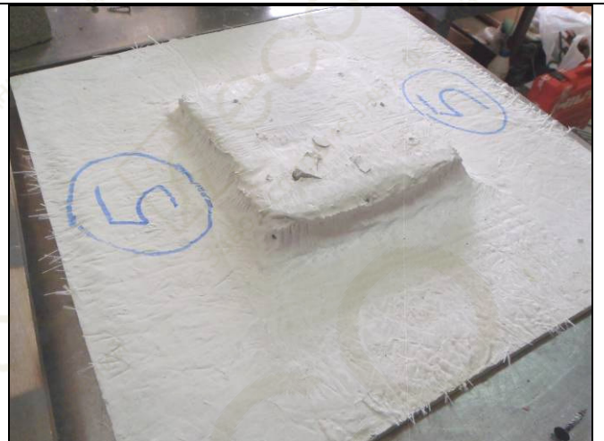
Фото 20. Испытание крепежного подвеса потолочной панели из фиброгипса. Испытание №5. Крепление на 4 шурупах. Вид образца после испытаний. Вырыв шурупов.
