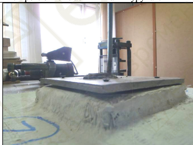
Фото 11. Испытание крепежного подвеса потолочной панели из фиброгипса. Испытание образца № 2. Вырыв шурупов.
