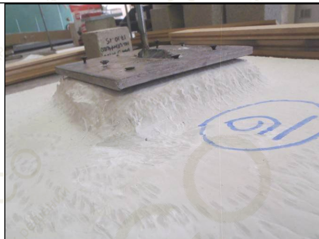
Фото 32. Испытание крепежного подвеса потолочной панели из фиброгипса. Испытание образца № 9. Крепление на 8 шурупах. Вырыв шурупов.
