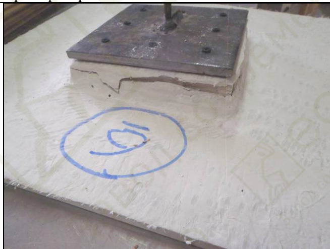
Фото 23. Испытание крепежного подвеса потолочной панели из фиброгипса. Испытание образца № 6. Крепление на 8 шурупах. Вырыв фанерной пластины.
