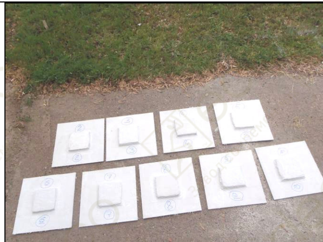
Фото 7. Испытание крепежного подвеса потолочной панели из фиброгипса. Образцы №№ 2-10, изготовленные для испытаний.
