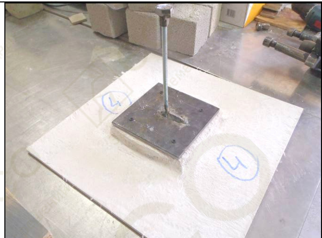
Фото 14. Испытание крепежного подвеса потолочной панели из фиброгипса. Образец № 4. Крепление пластины на 4 шурупах.
