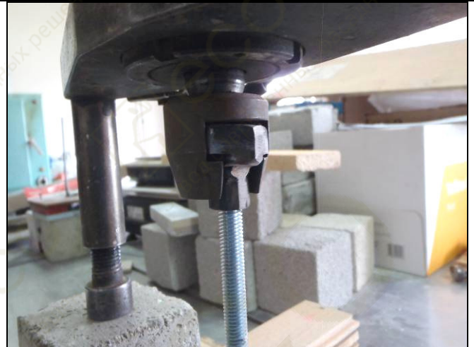
Фото 2. Закрепление крепежного подвеса к прибору ПОС-50 МГ4.
