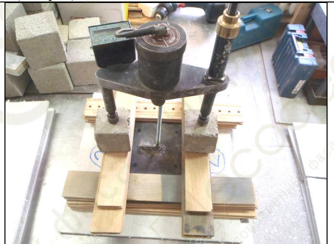
Фото 10. Испытание крепежного подвеса потолочной панели из фиброгипса. Испытание образца № 2.
