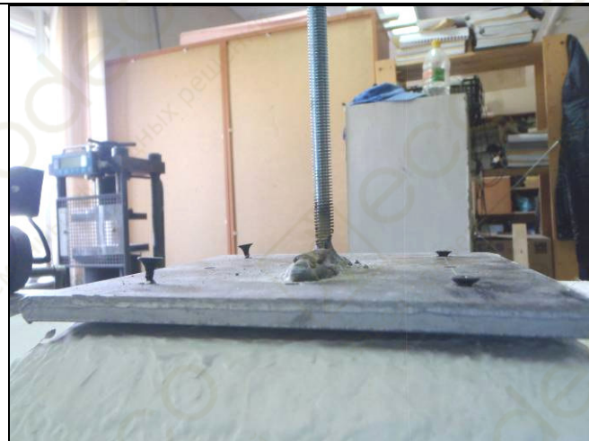
Фото 13. Испытание крепежного подвеса потолочной панели из фиброгипса. Испытание №3. Крепление на 4 шурупах. Вид образца после испытаний. Вырыв шурупов.
