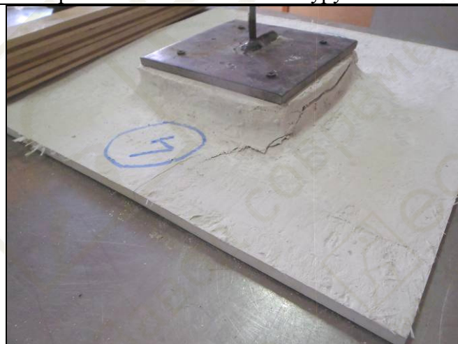
Фото 17. Испытание крепежного подвеса потолочной панели из фиброгипса. Испытание образца № 4. Вырыв фанерной пластины.
