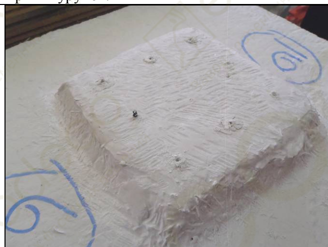
Фото 33. Испытание крепежного подвеса потолочной панели из фиброгипса. Испытание образца № 9. Крепление на 8 шурупах. Вырыв шурупов.
