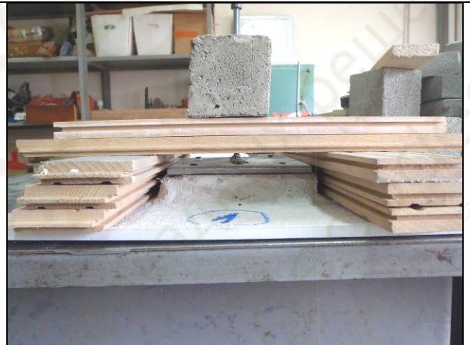
Фото 4. Испытание крепежного подвеса потолочной панели из фиброгипса. Общий вид испытательной установки сбоку. Видна анкерная пластина.
