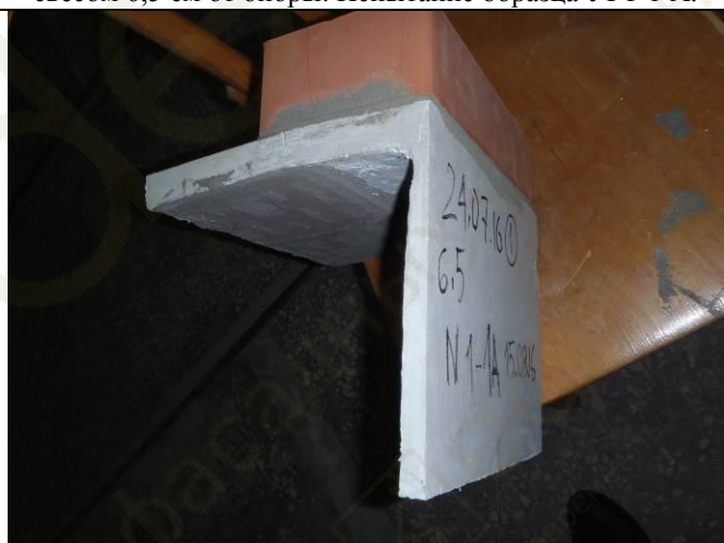
Фото 10. Образец уголка декоративных накладок из стеклофибробетона УГ 1-1А после испытания.
