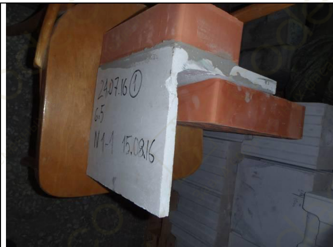
Фото 7. Образец для испытаний собран из уголка из стеклофибробетона и 3 кирпичей на цементно-песчаном растворе.
