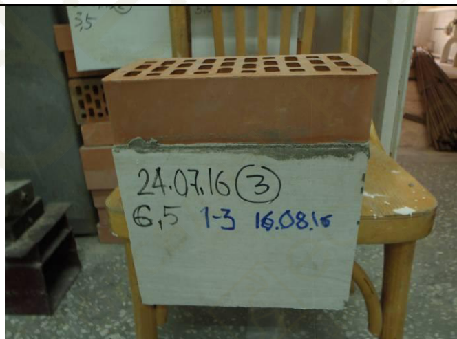
Фото 16. Образец уголка декоративных накладок из стеклофибробетона УГ 1-3 после испытания.
