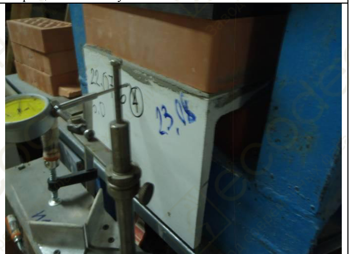
Фото 42. В ходе опыта определяем величину разрушающей нагрузки и величину перемещений (по установленным индикаторам) при заданной величине консольного свеса образца.
