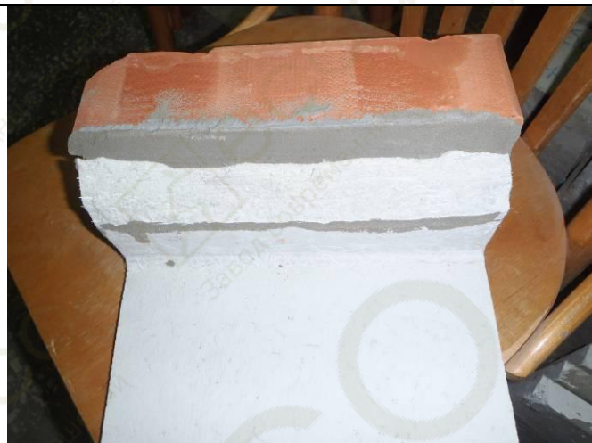
Фото 44. Видим скол полки уголка по длине образца.
