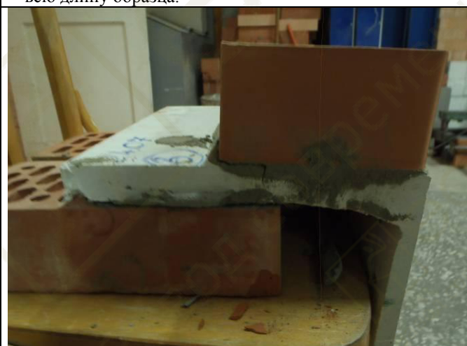
Фото 17. Осмотр дефектов после разрушения образца УГ1-3. Наклонная трещина в полке образца под действием нагрузки.
