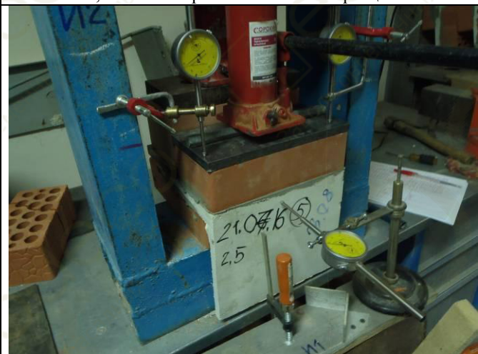
Фото 33. В ходе опыта определяем величину разрушающей нагрузки и величину перемещений (по установленным индикаторам) при заданной величине консольного свеса образца.
