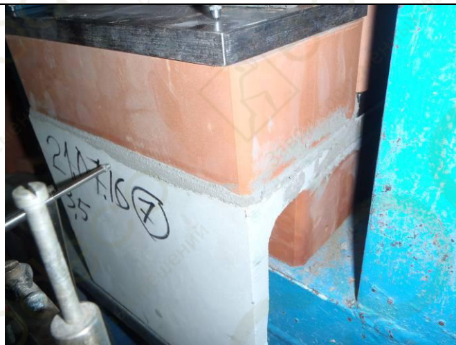
Фото 39. Осмотр дефектов после разрушения образца.
