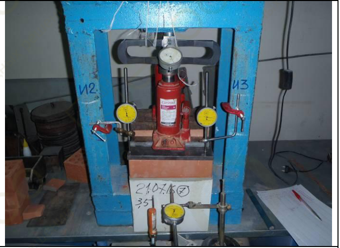
Фото 38. Общий вид испытательного стенда для определения максимального свеса полки уголка декоративных накладок-уголков из стеклофибробетона. Испытание образца УГ 3-7.
