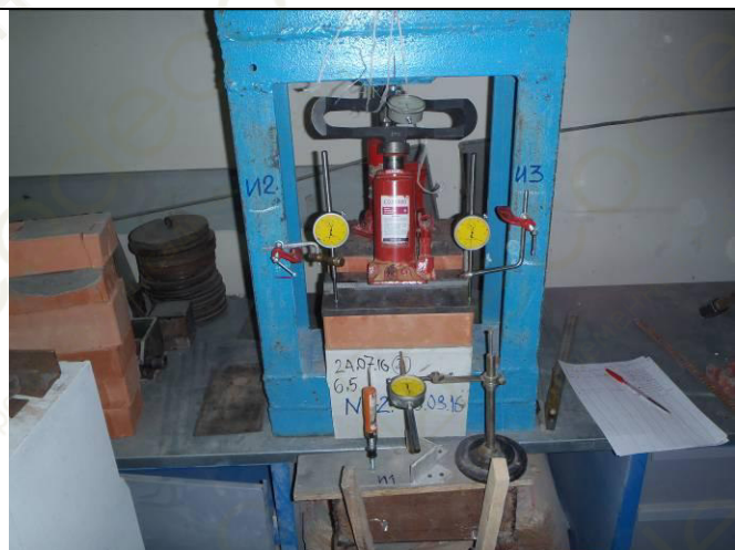
Фото 12. Нагружение на образец УГ 1-2 создается домкратом (в силовой раме) ступенями с фиксацией по шкале динамометра (типа ДОСМ-3-5).
